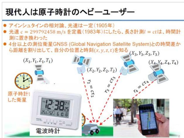
もうひとつ、工学的にも大成功していると思うのが、電波時計です。電波時計は、スーパーに行くと 980 円で売っているのです、いつの間にか家中に何台もあります。複数時計を持つと、時間合わせが面倒くさいのですが、電波時計は勝手に原子時計に時間を合わせてくれます。電池さえあれば、調整不要で正確な時を刻みます。このように非常に正確な原子時計の時間が身の回りに溢れているのが現在の状況です。
