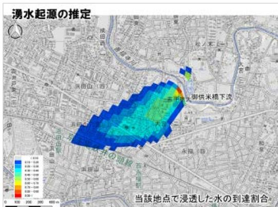
逆に、この湧水がどこの水が集約されて湧水となっているのか、ということもシミュレーション結果を解析することでわかります。左の図は赤いポイントで示した湧水が、どの地域の水が集まってできているかを示したものです。この結果は、例えば、湧水を守るため
